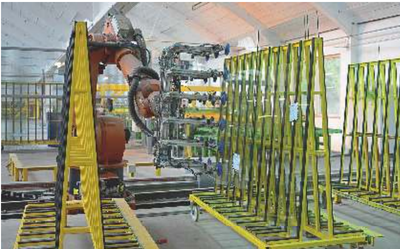
Automatisches Abstellen und Sortieren im Zuschnitt: Die korrekte Bereitstellung der Scheiben ist die Voraussetzung für sichere Fertigungsprozesse und den zügigen Produktionsdurchlauf.
