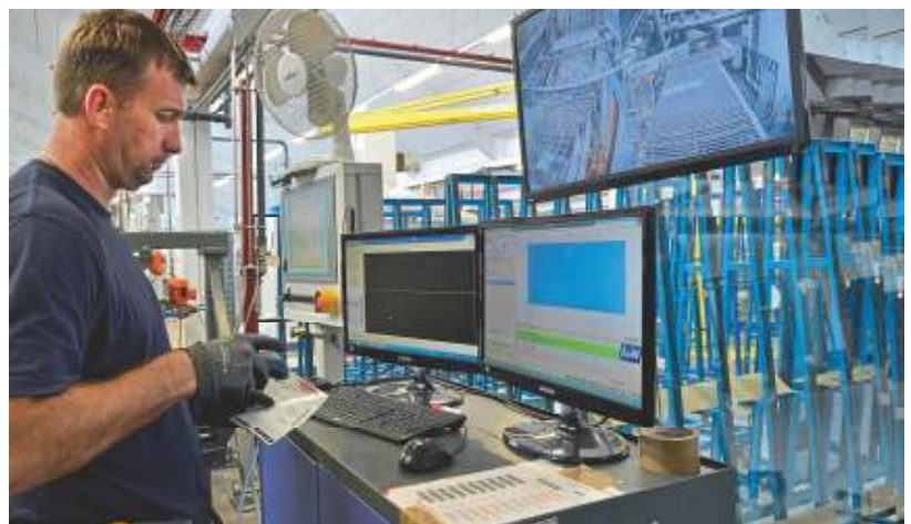
Die Identifizierung der Scheibe und die Auslösung der Produktion geschehen per Barcodelesung, alle wichtigen Daten visualisiert das A+W Production Terminal.
