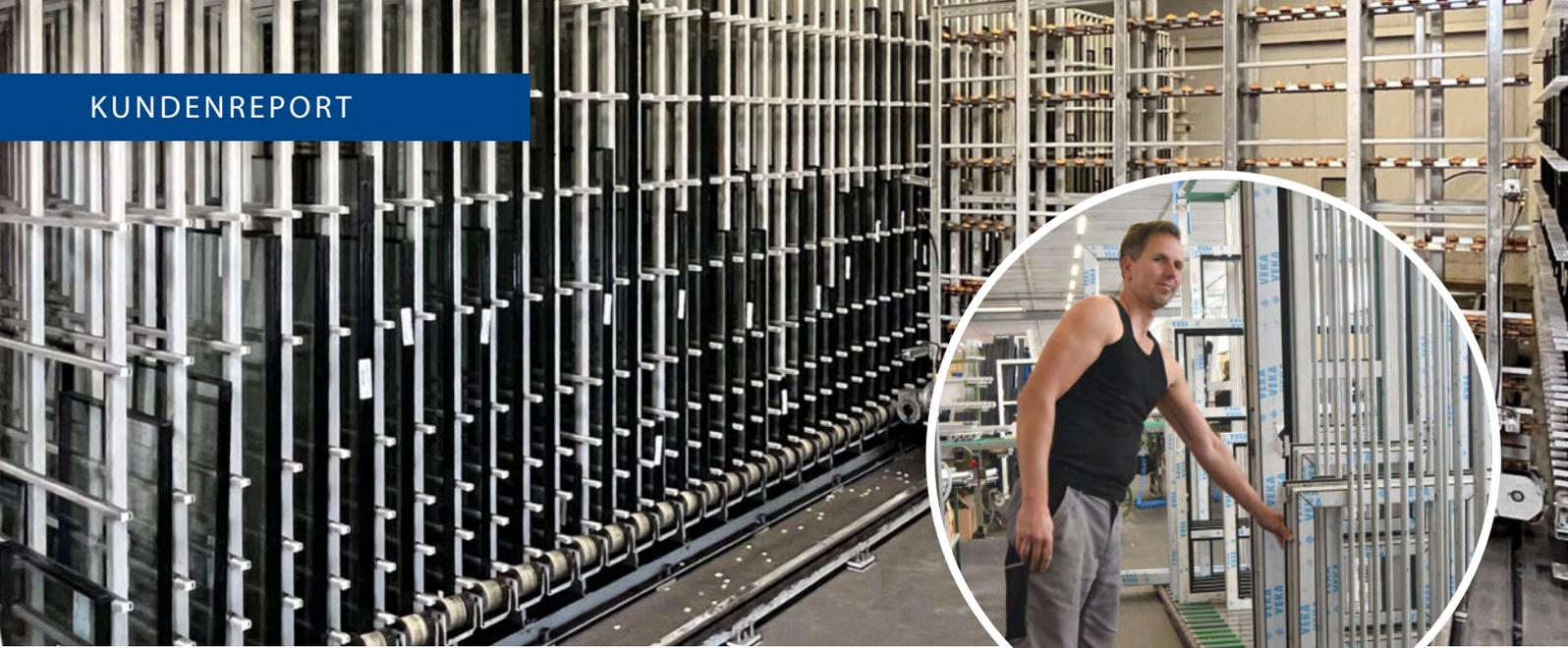
Über intelligente Puffer, Transportstrecken und Sortieranlagen wird sichergestellt, dass jedes Element und jede Isolierglaseinheit zur richtigen Zeit am richtigen Ort bereitstehen. Dieses voll vernetzte System wird zuverlässig von A+W Cantor CIM-Software gesteuert.
