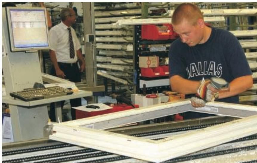
*Papierlose Produktion: An den Beschlagsarbeitsplätzen werden die Mitarbeiter durch detaillierte grafische Anzeigen der Beschlagteile, selbst für den Sonderbau, unterstützt. Insgesamt stehen in der PVC-Fertigung von al bohn 47 Cantor CIM-Bildschirmarbeitsplätze.*
