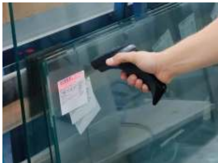
Papierlos und durchgängig vernetzt: Das Barcode-Etikett enthält alle zur Fertigung der Scheibe notwendigen Informationen
