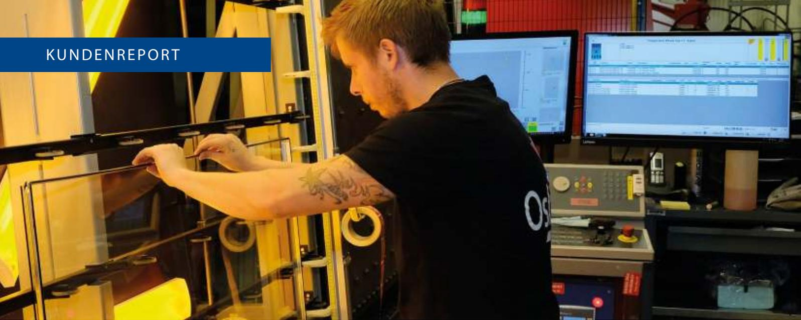
Richtige Scheibe? Korrekte Ausrichtung? An der Visitierstation unterstützt das A+W Production Terminal den Werker beim fehlerfreien Zusammenbau der Isolierglaseinheiten
