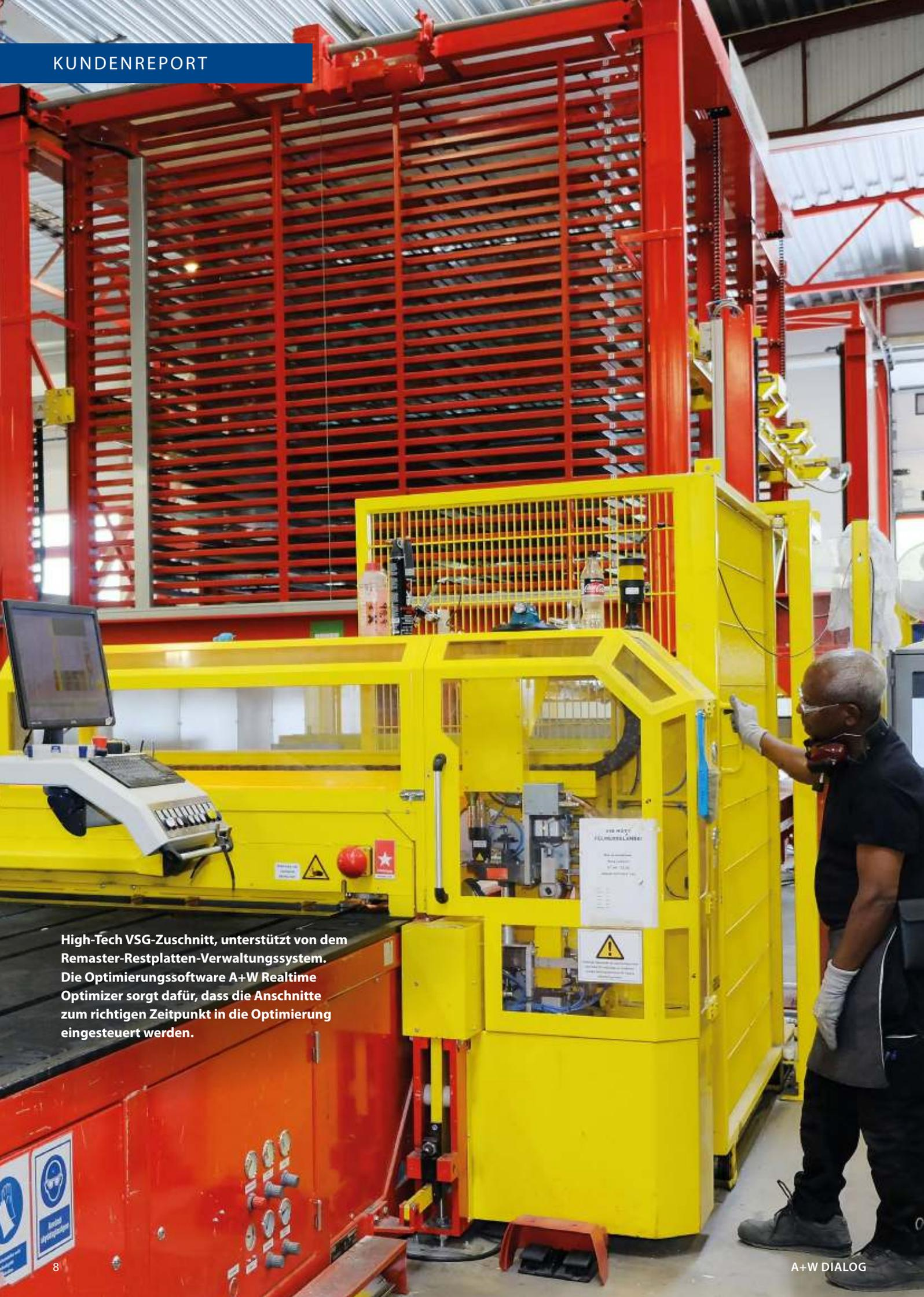
High-Tech VSG-Zuschnitt, unterstützt von dem Remaster-Restplatten-Verwaltungssystem. Die Optimierungssoftware A+W Realtime Optimizer sorgt dafür, dass die Anschnitte zum richtigen Zeitpunkt in die Optimierung eingesteuert werden.
