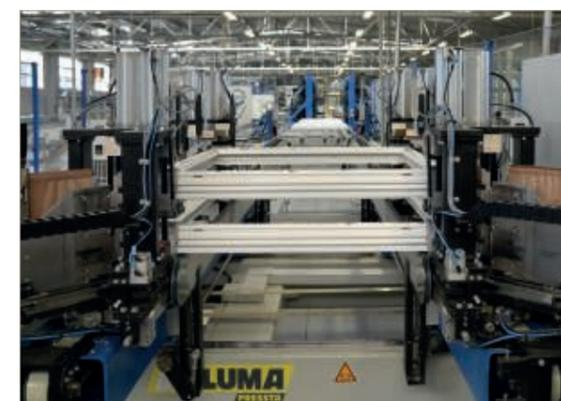
Vollautomatisches Schweißen auf der Stürtz-Schweißanlage. INCON ‚fährt‘ für Rahmen und Flügel zwei Fertigungslinien parallel; intelligente Puffer am Ende der Linien helfen, dass sich die ‚Pärchen‘ bei der Hochzeit finden, auch wenn einer der Beteiligten später als vorgesehen eintreffen sollte.
