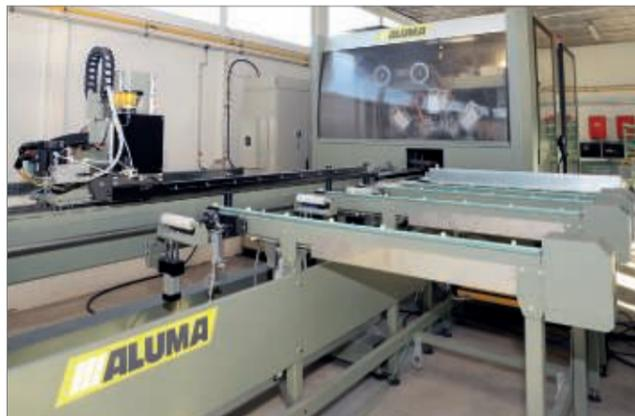
Links: Stabbearbeitung in der Aluminium-Fertigung: Die CANTOR-gesteuerte Quadra L1 erledigt schnell und präzise sämtliche Bohr-, Fräs- und Schneidaufgaben. Rechts: Solide Facharbeit und langjährige Erfahrungen ermöglichen Aluminium-Bauelemente mit perfekter Funktionalität und makellosem Finish wie diese Hebe-Schiebetür.
