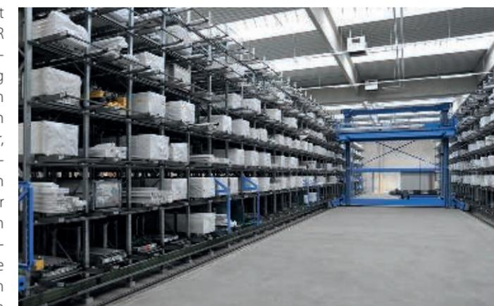
Intelligentes Materialmanagement im Fensterbau: Vollautomatisch gesteuertes Profillager
