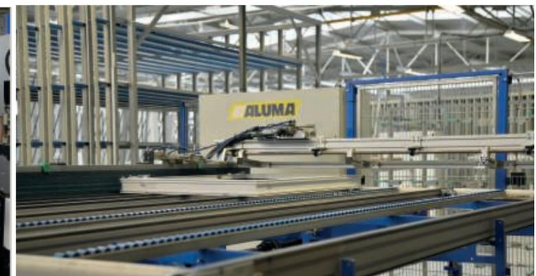
Am Ende der automatischen Transportstrecke werden die Bauteile aufgerichtet und in einen vertikalen Puffer eingestellt.
