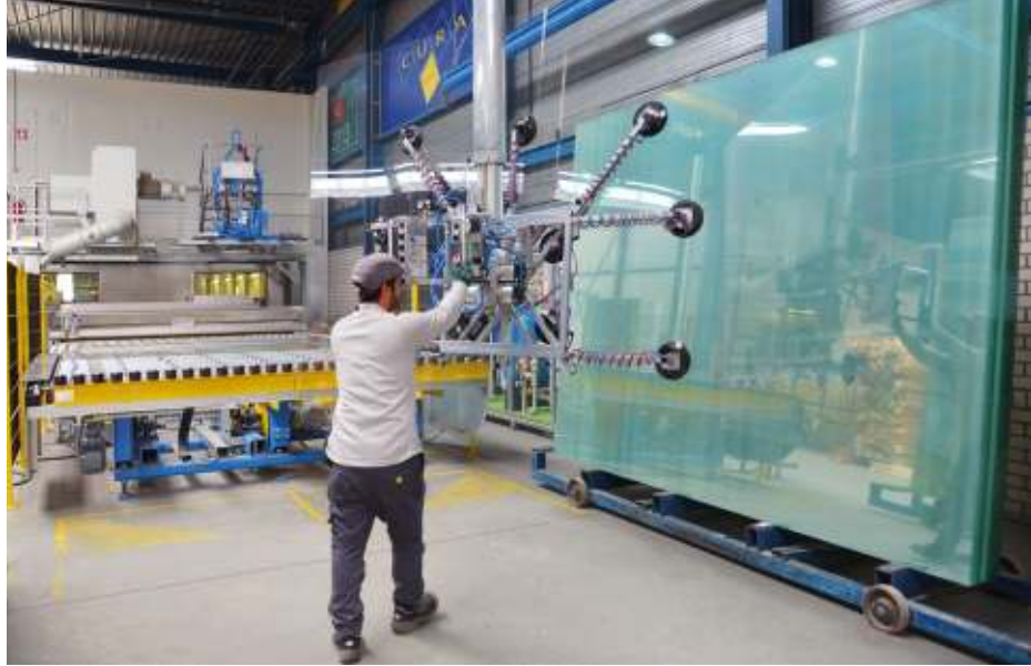
Laminiertes Glas aus geteilten Bandmaßen: Einlauf der vollautomatischen Benteler-VSG-Fertigungslinie
