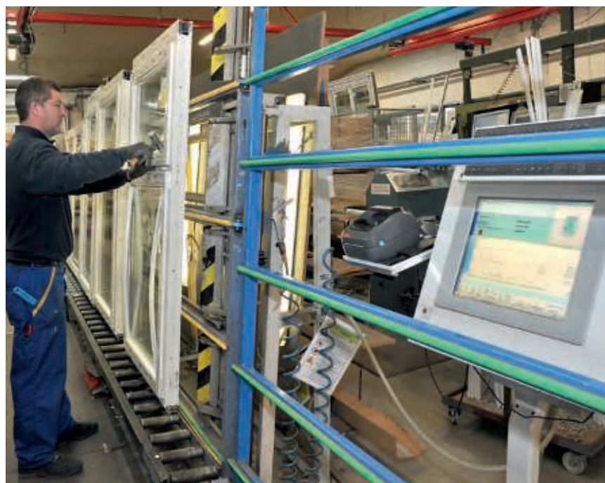
Welche Scheibe gehört zu welchem Flügel? Die benötigten Informationen werden übersichtlich am Monitor an der Verglasungslinie bereitgestellt.
