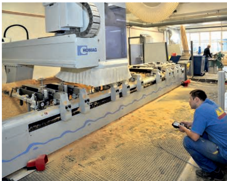
Das moderne, von A+W Cantor-Software gesteuerte Homag CNC-Holz-Bearbeitungszentrum. 90 mm Profile sind bei AJM Holzfenstern Standard.
