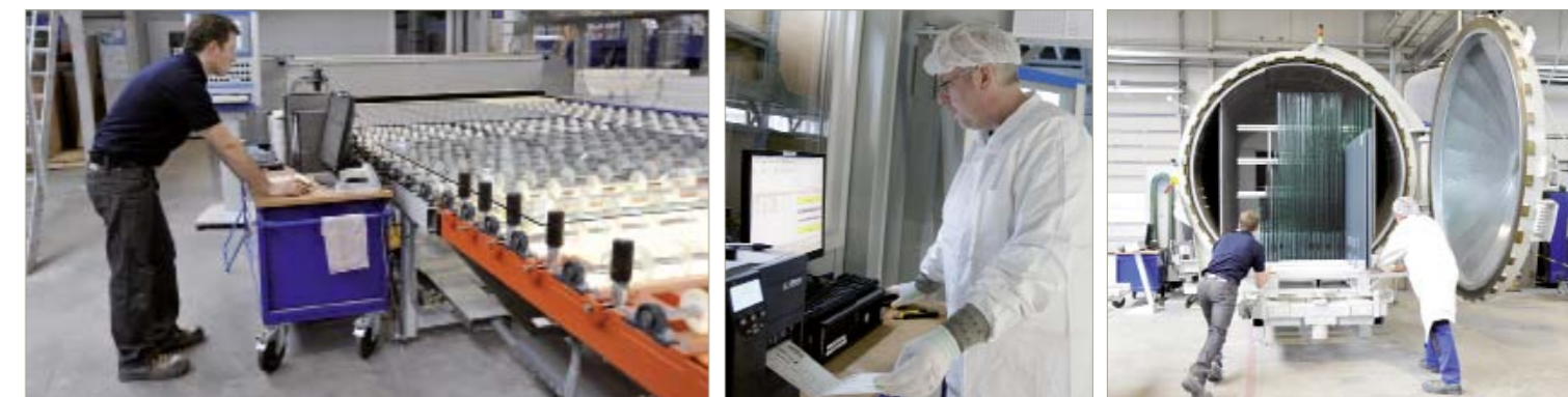
Auch die VSG Produktion ist durchgängig vernetzt gesteuert. Links: Der Mitarbeiter meldet die Einzelscheiben per Barcodescan im Reinraum an und entfernt die Etiketten. Im Reinraum (Mitte) informiert das ALCIM Leitrechnersystem ToolTV über die Parameter des aktuellen Scheibenpaars, den Aufbau und die einzuliegende(n) Folie(n). Bevor die Scheiben an den Vorverbund übergeben werden, meldet der Bediener sie per Barcodelesung fertig und stößt den Etikettendruck an. Rechts: Autoklave für große Aufgaben - wie alle Maschinen bei Sencoglas Glastechnik ist er für Scheiben bis zu 6,00 x 2,80 m ausgelegt.
