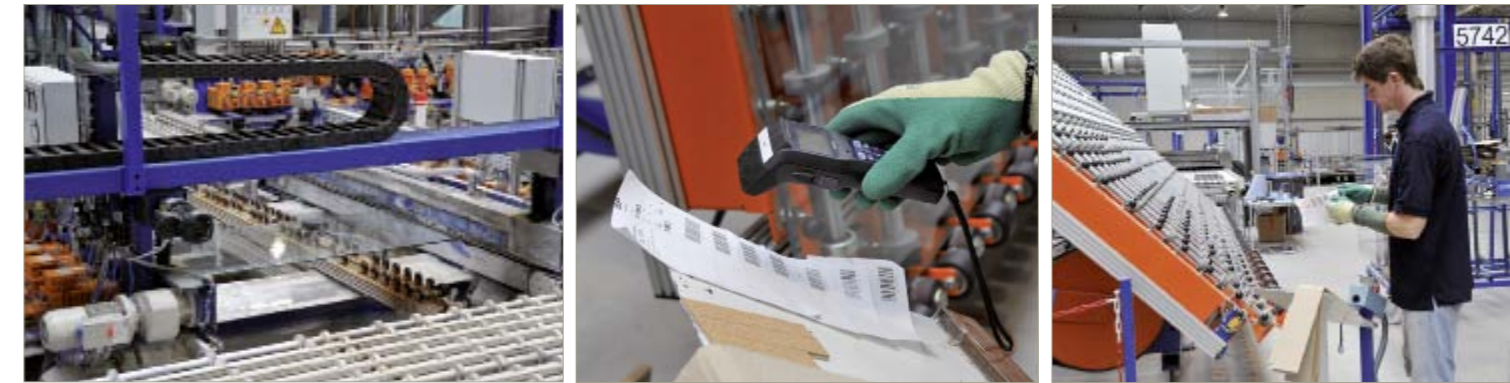
Bis auf wenige Ausnahmen das einzige Produktionspapier bei Sencoglas Glastechnik: Das Etikett. Es enthält sämtliche Informationen, um die Scheibe identifizieren und durch die Produktion verfolgen zu können. Mit der Barcode-Registrierung im Auslauf der Schleif-/Bohr-/Frässtraße wird die Scheibe für diese Bearbeitungsstation als fertig gemeldet und der Folgetechnologie zugewiesen.
