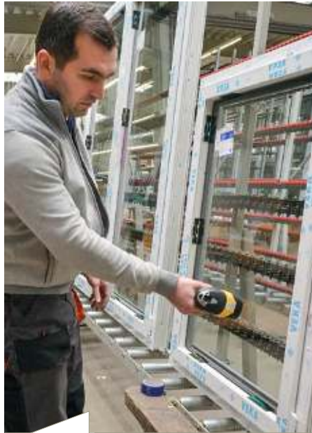
Via Barcode werden Fertigungsinformationen ausgelesen oder, wie hier in der Verglasung, Statusinformationen ins ERP-System zurückgemeldet.
