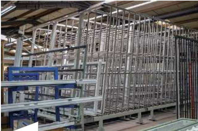
Über Transportstrecken und Software-gesteuerte Shuttles werden die Rahmen und Flügel zwischen den Bearbeitungsstationen weiterbefördert und in intelligente Puffer verbracht. Auch das Isolierglas wird über Puffer mit eindeutigen Stellplätzen in die Verglasung eingesteuert.
