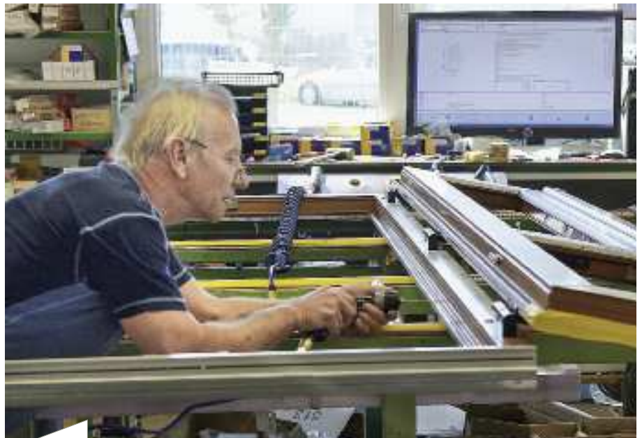
Die Fertigung bei Reckendrees wird vom Produktions-Steuerungssystem Cantor CIM praktisch papierlos per Betriebsdatenerfassung und Monitoranzeige gesteuert, das Barcode-Etikett ist der wichtigste Informationsträger.
