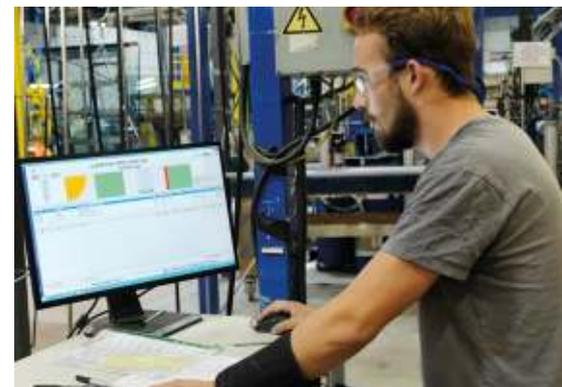
A+W Production Monitor an der Visierstation der Isolierglas-Linie: Scheibenaufbau, Schichtlage und korrekte Ausrichtung werden übersichtlich angezeigt
