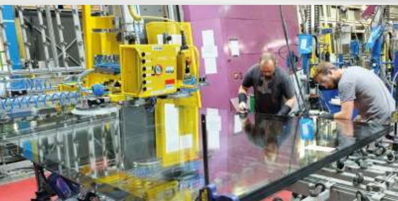
Solche Scheiben kann nicht jeder: Dreifach-Stufen-Isolierglas im Großformat
