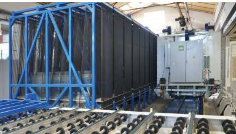
Zuschnitt mit höchster Performance, maximaler Ausbeute und Wunschsequenz für Iso und Bearbeitung: Das A+W DynOpt-gesteuerte Sortiersystem wurde für die komplexen Anforderungen von Teutemacher maßgeschneidert.
