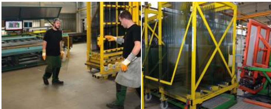
Höchste Effizienz bei Zuschnitt, Sortierung und Iso-Beschickung: Der automatische Isolierglaseinzug (rechts) ist die ideale Ergänzung der von A+W Dynopt gesteuerten automatischen Sortierung mit dem HEGLA SortJet.
