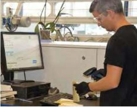
Dank durchgängiger Betriebsdatenerfassung sind alle nötigen Statusinformationen an den Bearbeitungsstationen verfügbar und können am A+W Production Monitor angezeigt werden.
