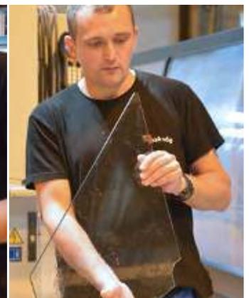
Petter Rakvåg erfasst eine Modellscheibe mit mehreren Bearbeitungen und kennzeichnet sie als Eilauftrag. Via CAM-DXF werden die Produktionsdaten an das CNC-Bearbeitungszentrum weitergeleitet, wo der Maschinenführer über den A+W Production Monitor die Fertigung auslöst und das Etikett ausdruckt. Binnen einer Stunde ist die Scheibe fertig zur Auslieferung.
