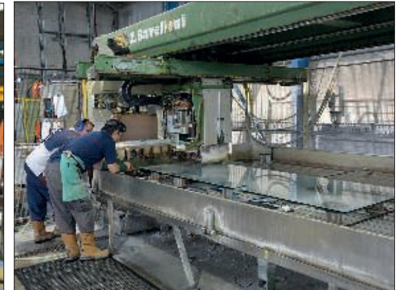
Auf seinen in das A+W Netzwerk eingebundenen vollautomatisch gesteuerten CNC-Bearbeitungsmaschinen fertigt FGI Glas für Interieur-Anwendungen wie Trennwände, Tischplatten, Duschtüren, Ganzglasanlagen etc.
