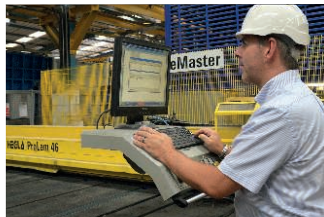
Auf der HEGLA Kombi-Schneidlinie kann VSG im flexiblen Wechsel mit Float geschnitten kann. Die Restplatten werden in einem HEGLA Remaster Storage-System vorgehalten und durch die A+W Optimierung situationsgerecht in die laufende Produktion eingesteuert.
