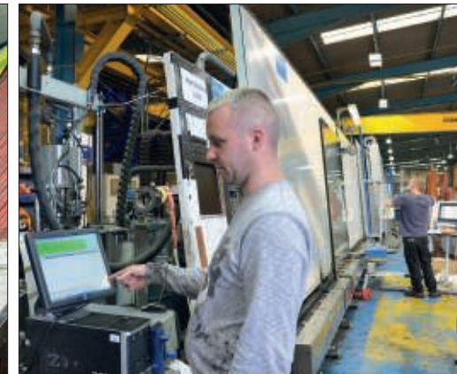
A+W Production Monitor im Auslauf der Bystronic Isolierglaslinie: Jede produzierte Scheibe wird registriert, bei Bruch- oder Schlechtscheiben wird die Nachfertigung angestoßen.
