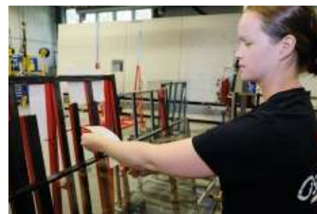
Iso-Einheit produziert und auf Versandgestell verpackt: Das Barcode-Etikett enthält alle wichtigen Scheibeneinformationen
