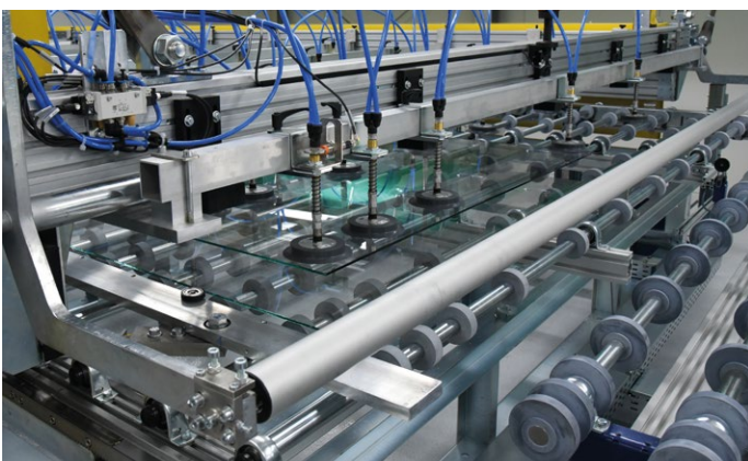
Vollautomatische VSG-Fertigung mit der neuen Benteler-Anlage
