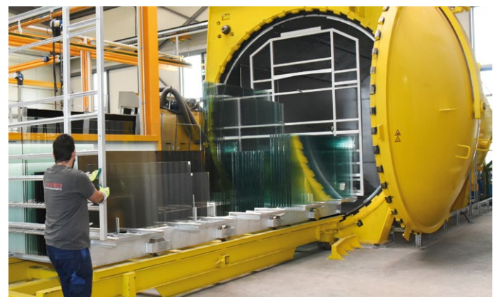
Fertig „gebacken“: VSG-Scheiben werden aus dem Autoklaven austранportiert
