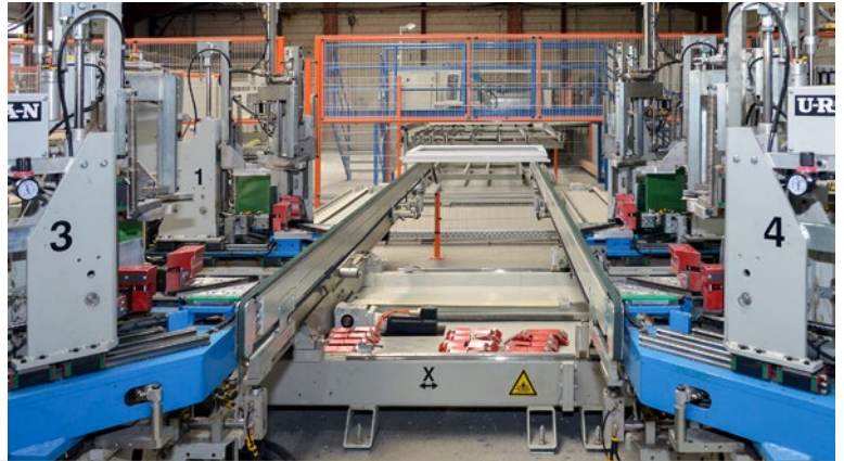
Über Transportstrecken und Software-gesteuerte Shuttles werden die Rahmen und Flügel zwischen den Bearbeitungsstationen weiterbefördert und in intelligente Puffer verbracht. Auch das Isolierglas wird über Puffer mit eindeutigen Stellplätzen in die Verglasung eingesteuert.
